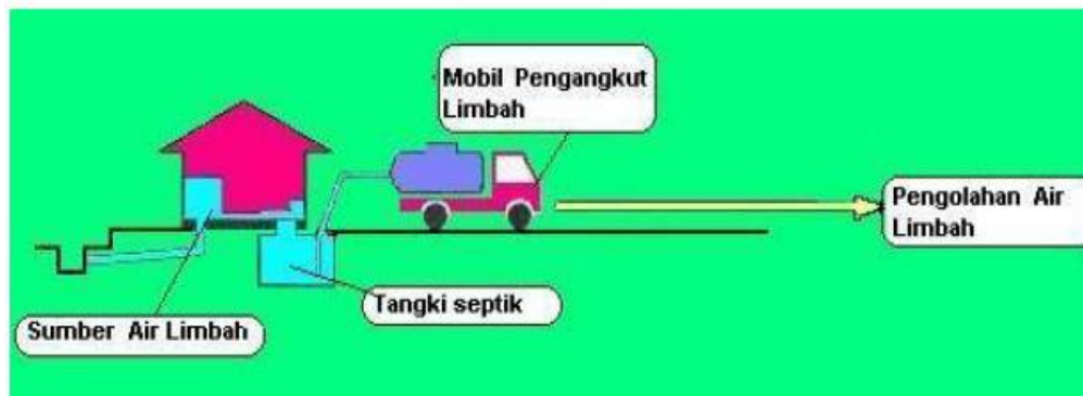
Gambar 2.2. Diagram Sistem Pengolahan Limbah Tinja Sistem setempat (on site sistem)
