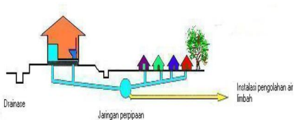
Gambar 2.1. Diagram Sistem Pengolahan Limbah Tinja Sistem Terpusat ( Off Site )
