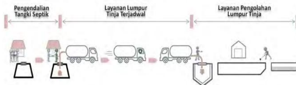
Gambar 2.10. Diagram Pengolahan LLTT Sumber: IUWASH, 2016
