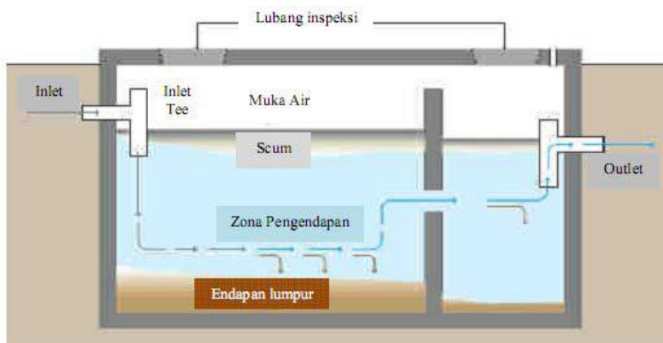
Gambar 2.5. Zona-zona dalam Tangki Septik Sumber : Kementerian Pekerjaan Umum, 2013
