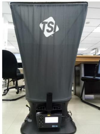
Gambar 3.10 *Balometer* dengan Hood
