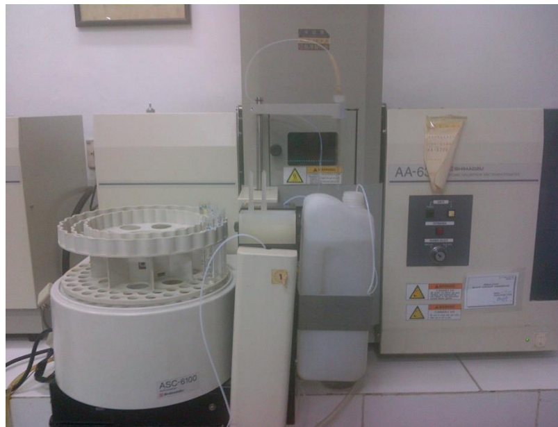
Gambar 5. Spektrofotometer Serapan Atom (AAS)
