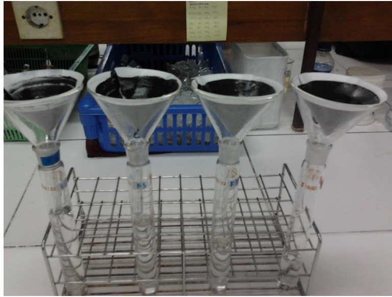
Gambar 3. Penyaringan setelah pengadukan dengan karbon aktif.
