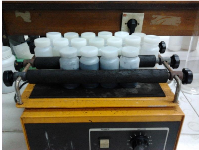
Gambar 4 Sampel setelah penambahan adsorben siap di shaker.
