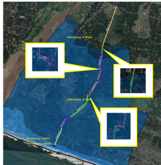
Gambar 6 Segmen jalan pada jalur evakuasi pantai Kuwaru yang terdampak luas genangan (inundasi) dari masing – masing ketinggian gelombang
