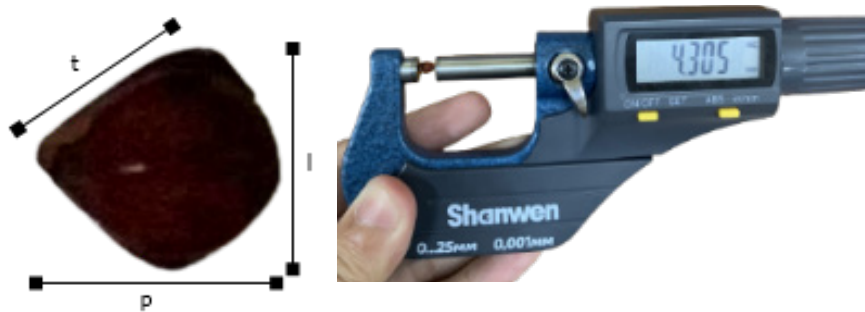
Gambar 7. Pengukuran dimensi biji sorgum cokelat tua dengan jangka sorong digital (Dokumentasi pribadi, 2022)
