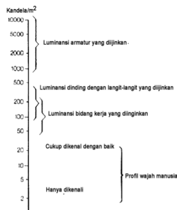
Gambar 2.5 Skala luminansi untuk pencahayaan interior Sumber: SNI 03-6575-2001
